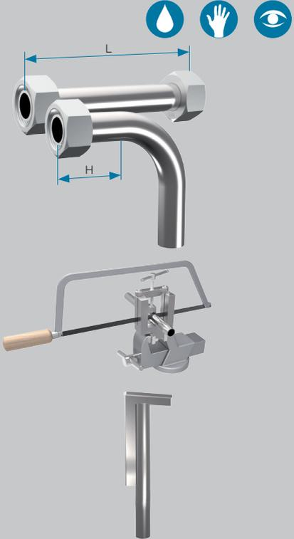
Para el premontaje mecanizado se deben consultar las longitudes mínimas en el manual de instrucciones respectivo del equipo de premontaje.
