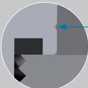
Les bouchons d'obturation de forme N avec filetage du tube Whitworth possèdent une rainure de repérage
