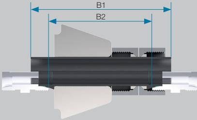
Lunghezze minime per il serraggio dei tubi curvati (R ≥ 3x D est. tubo).
